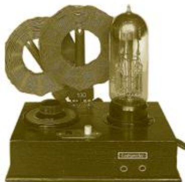
Rádioprijímač s kombinovanou elektrónkou (firma LÖWE)
